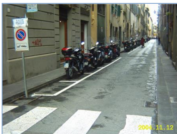
Εικόνα 17: Ενδεικτική απεικόνιση χωροθέτησης δικύκλων παρά το κράσπεδο μέσω οριζόντιας και κατακόρυξης σήμανσης.
